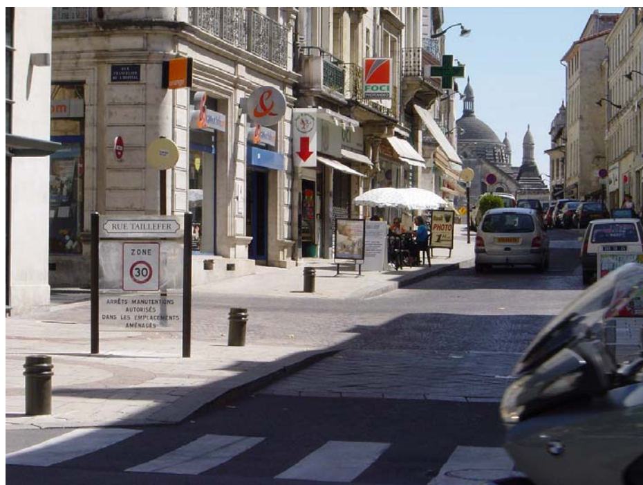
Figura B.43 - Una porta di una “zona 30” evidenziata mediante una soglia visiva (segnaletica) e fisica (attraversamento sopraelevato)
