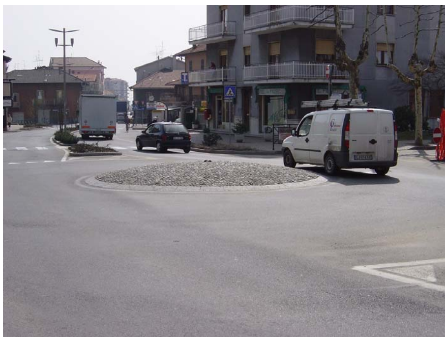
Figura B.20 - Una minirotonda con l'isola centrale sormontabile dai mezzi pesanti
