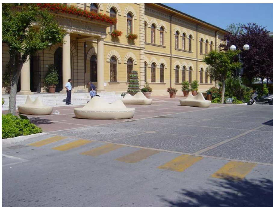
Figura B.24 - Un attraversamento pedonale rialzato di grandi dimensioni, posto davanti a un edificio pubblico
