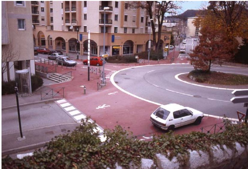
Figura B.21 - Il modello di minirotatoria e rotatoria compatta adottato a Chambéry, combinato con la piattaforma rialzata
