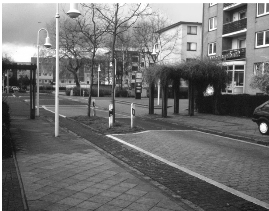
Figura B.37 - Una strettoia con passaggio laterale riservato per i ciclisti
