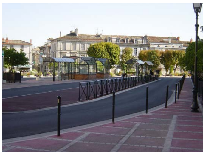
Figura B.11 - Le fermate dei mezzi pubblici dovrebbero essere esterne alla carreggiata veicolare, protette da transenne e prive di barriere architettoniche
