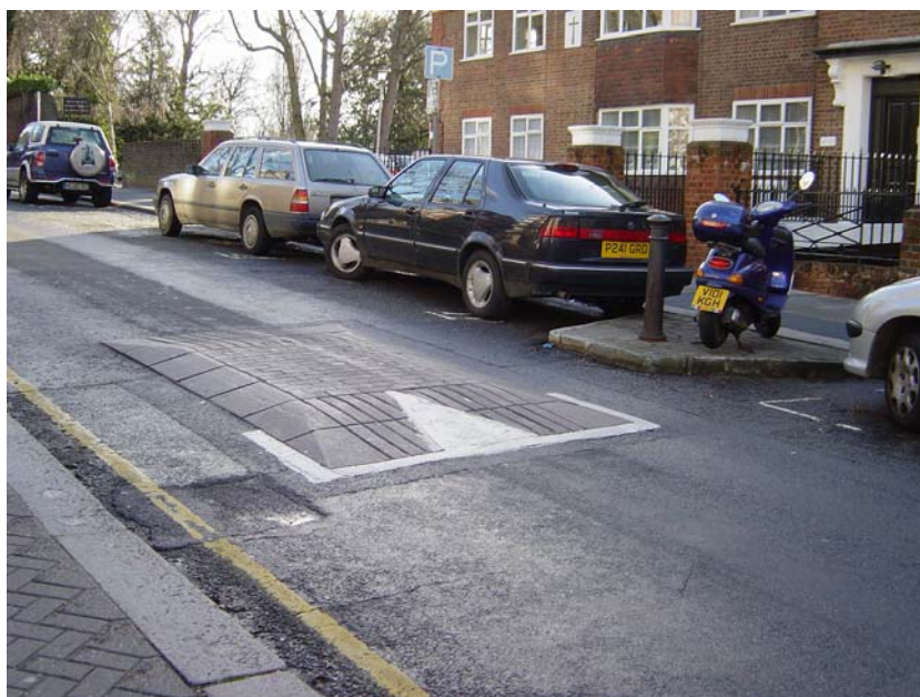
Figura B.33 - Un dissuasore posto su un gradino impedisce di aggirare il cuscino quando i posteggi sono vuoti
