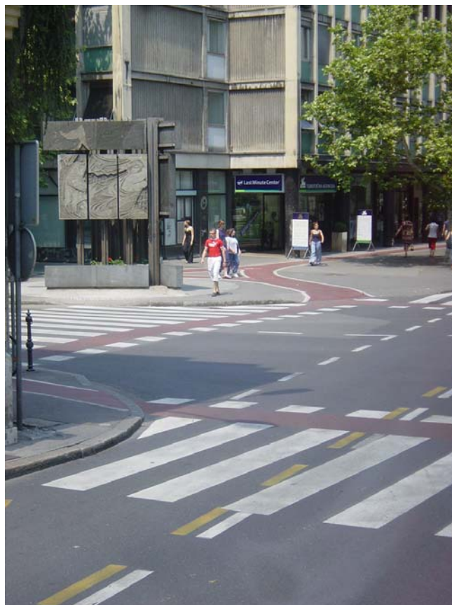
Figura B.8 - È consigliabile che le piste ciclabili abbiano una pavimentazione colorata, ben visibile rispetto alle altre parti della strada
